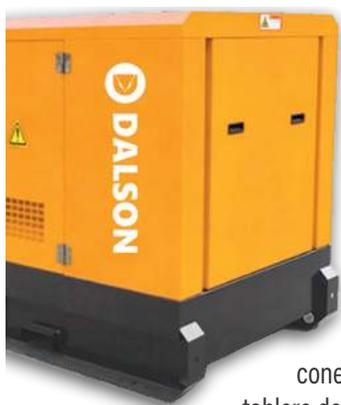
Línea de generación insonorizados, certificación SEC, ganchos de izaje incorporados, chasis robusto, diseñado para uso de montacargas, especialmente para aplicación de arriendo. Componentes de calidad, motorización Perkins con turbo, alternador Stamford, controlador COMAP AMF-25, conexiones Schuko y conexión para tablero derivación, montados desde fábrica.
