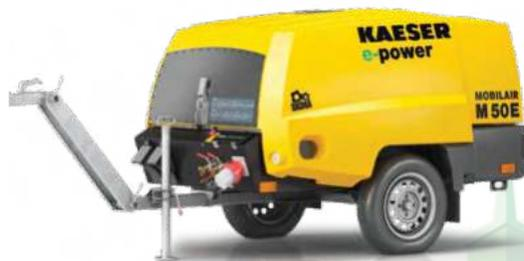
Los nuevos compresores portátiles para obras pueden utilizarse en cualquier lugar donde haya una conexión a la red eléctrica. El accionamiento eléctrico permite ingresar en zonas de bajas emisiones (tanto de gases como de ruido). Esta característica es ideal para trabajar dentro de edificios o túneles. Gracias a su bajo consumo energético y el poco gasto de mantenimiento, son ideales para sustituir temporalmente estaciones industriales de compresores con la mayor flexibilidad.
